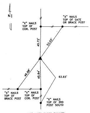
DISTANCES SLOPE CHAINED S1/4 CORNER SECTION 11-84-38
