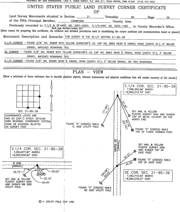
ALL MEASURED DISTANCES SHOWN ARE HORIZONTAL, ALL RECORD DISTANCES (##") SHOWN ARE SLOPED CHAINED
